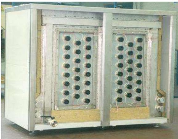
Onde sonore con frequenze che vanno oltre le soglie di percezione dell'udito umano (sopra i 16 kHz) vengono più comunemente chiamate **Ultrasuoni**. Un generatore crea un'alta frequenza elettronica e un trasduttore la trasforma in una vibrazione oscillatoria che crea a sua volta una intensa vibrazione meccanica ad alta frequenza al secondo.
