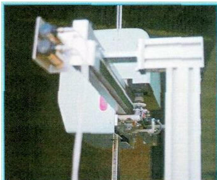
Sensore di posizione e sistema di alimentazione a spazzole
